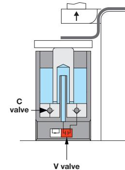
**FR** Lors de la course de retour de la presse, le vérin DCG reste en position de compression finale, avec un retour élastique maximal de 1 mm en raison du faible volume de gaz restant dans la chambre inférieure du vérin DCG. La soupape (V) sur le fond du vérin reste fermée. Si la course réelle du vérin DCG est inférieure à la course réglée de  $\pm 0,5\text{ mm}/0.02\text{ inch}$ , le retour élastique sera supérieur à 1 mm/0.04 inch.
