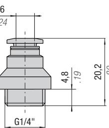
Innesti rapidi tubo - tubo - Hose to hose couplings - Schnellkupplungen Leitung - Leitung - Raccords rapides tuyau à tuyau - Enchufes rápidos tubo - tubo - Engates rápidos reto - tubo.
