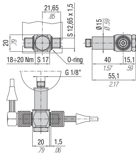
Bloccetto di distribuzione - Distribution block - Gasverteilstück - Plot de distribution - Bloque de distribución -
