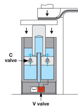
**IT** Il cilindro DCG viene compresso fino a fine corsa ( $\pm 0,5 \text{ mm}/0.02 \text{ inch}$ ). Il gas passa dalla camera inferiore alla camera superiore attraverso le valvole unidirezionali (C). La valvola (V) sul fondo del cilindro è chiusa.
