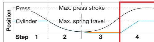
**IT** Quando viene attivata la valvola (V) sul fondo del cilindro DCG e la presa continua la sua corsa di ritorno, i cilindri ritornano nella condizione iniziale.
