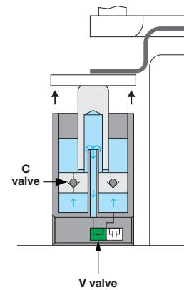
**DE** Wird das Ventil (V) am Boden des Zylinders DCG aktiviert, kann Gas aus der oberen Kammer in die untere Kammer zurückströmen, wodurch die Kolbenstange ausfährt und in ihre Ausgangsposition zurückkehrt.
