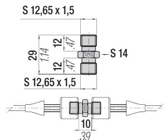
Blocchetto di distribuzione - Distribution block - Gasverteilstück - Plot de distribution - Bloque de distribución - Bloco de distribuição
