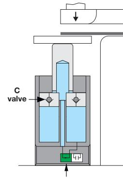
**IT** Fase iniziale del ciclo pressa con cilindro completamente esteso. Il movimento della presa non comprime ancora il cilindro. Il cilindro DCG comprende delle valvole unidirezionali (C) montate sul pistone e una valvola pneumatica (V) montata sul fondo.
