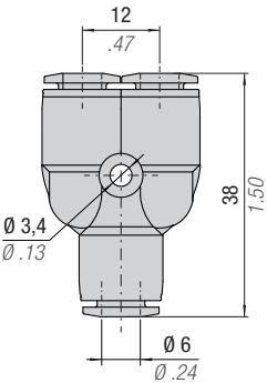
Innesti rapidi girevoli - Swivel quick couplings - Schwenkbare Schnellkupplungen - Raccords rapides pivotants - Enchufes rápidos giratorios - Engates rápidos giratório
