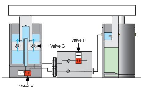
**FR** Le vérin DCG est comprimé jusqu'à la fin de sa course ( $\pm 0,5 \text{ mm}/0.02 \text{ inch}$ ). Le gaz passe de la chambre inférieure à la chambre supérieure par les clapets antiretour (C) montés sur le piston. La soupape (V) sur le fond du vérin DCG est fermée. Le vérin GP est comprimé et la pression de sa chambre supérieure est réduite. La soupape (P) du groupe reste fermée.
