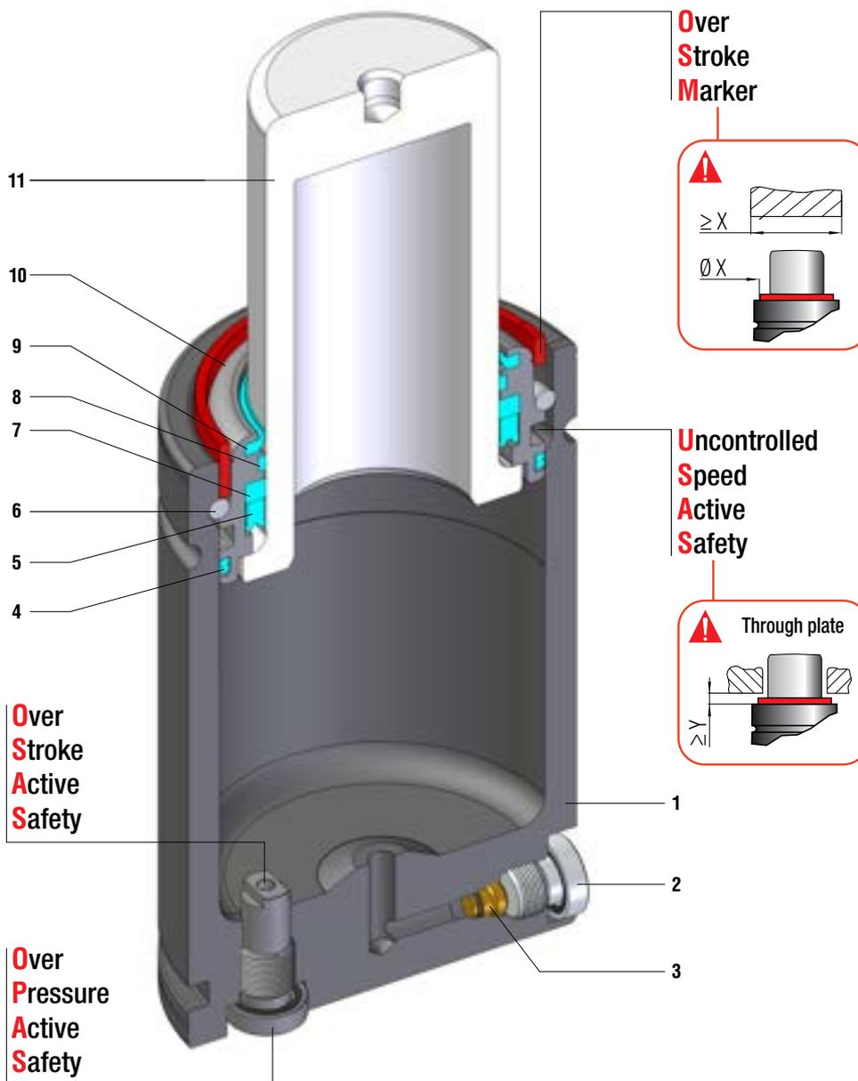
Minima altezza, massima forza, collegabili G1/8 - Minimum height, maximum force, hose cylinders with G1/8 charging port - Minimale Höhe, maximale Kraft, Gdf. mit G1/8 Öffnung verbindbar - Hauteur minimale, force maximale, cylindres raccordés avec trou G1/8 gaz - Mínima altura, máxima fuerza, cilindros conectados con agujero G1/8 gas - Altura mínima, força máxima, cilindros conectados com furo G1/8 gás
